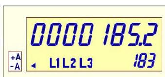
In diesem Beispiel wird die erzeugte Energie in unser Netz gespeist mit einer momentanen Leistung von 183 W.
